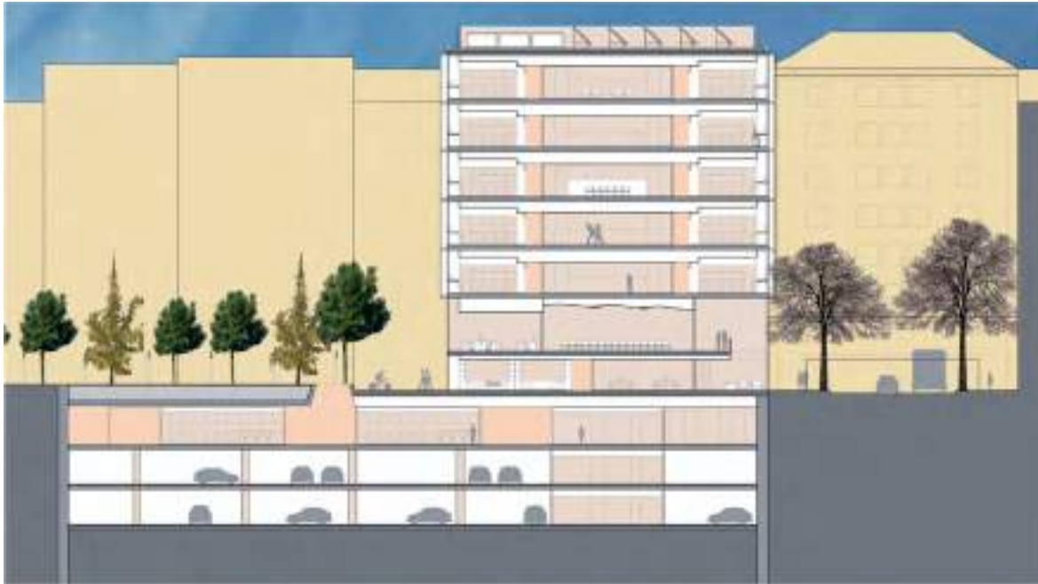
Sección transversal del Centro con el Hospital Clinic al fondo. La proximidad del metro añadió complejidad a las obras, requiriendo el Centro potentes medidas antivibratorias.
